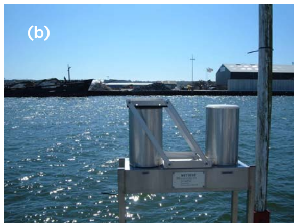
Figur 4. Eksempler på kampagnemåling ved brug af vindretningsbestemt støvfaldsopsamler "MET-DUST": Måling for støvnedfald nær ved en grusgrav (a), og måling nær et metalskrotanlæg (b). Foto: FORCE Technology.
