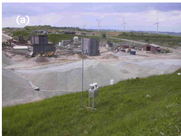
Figur 4. Eksempler på kampagnemåling ved brug af vindretningsbestemt støvfaldsopsamler "MET-DUST": Måling for støvnedfald nær ved en grusgrav (a), og måling nær et metalskrotanlæg (b). Foto: FORCE Technology.
