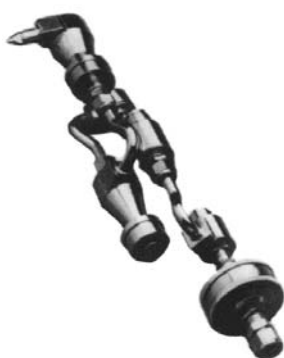
Figur 4. En PM_{10} cyklon til emissionsmåling, designet jf. USEPA Method 201
