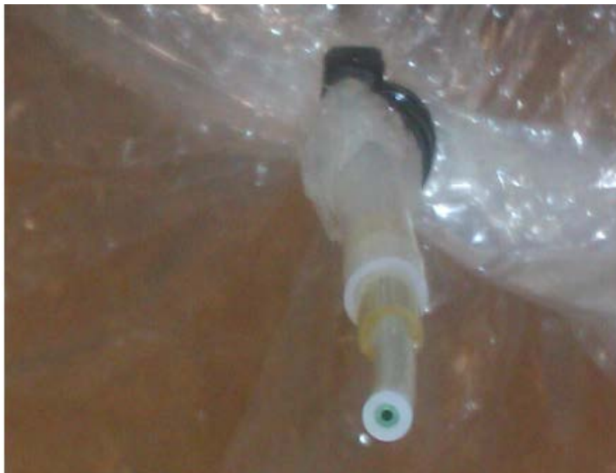
Forsøg 1: Billede af kapillarslange sat fast på udgangsstudsens fra posen. ID 0.75 mm – længde 40 mm
